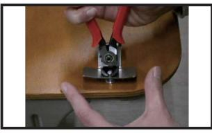
**4** 専用工具を傾けると、テコの原理でピンが浮きます。ピンを専用工具でつかんだ状態のまま、ピンを引き抜いてください。
