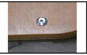
**5** リベットのピンが抜けた様子。 背座をフレームに止めている、それぞれ 4 つリベットのピンをすべて抜きます。
