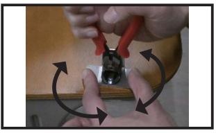
**3** 専用工具を回すように左右に動かすと、工具の刃がリベット頭とピン頭の間に入りやすくなります。
